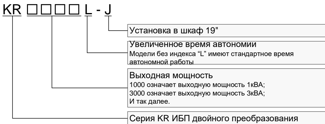
Рис 2.1 Обозначение ИБП мощностью менее 10 кВА
